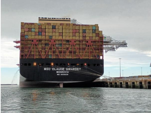
Ce navire est capable de transporter en moyenne 24 conteneurs en hauteur et a une longueur suffisante pour loger 48 conteneurs de 20 pieds pour la longueur. Un conteneur est caractérisé par sa longueur ; les plus communs sont les 20 pieds (6,1 mètres). Un conteneur standard d'un EVP, (Équivalent Vingt Pieds) mesure extérieurement 6,096 m de long (20 pieds), 2,438 m de large (8 pieds) et 2,591 m de haut.
