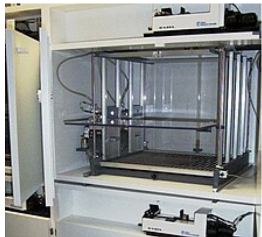
La boîte de Skinner, avec une grille électrifiée, deux leviers, deux lampes etc.
